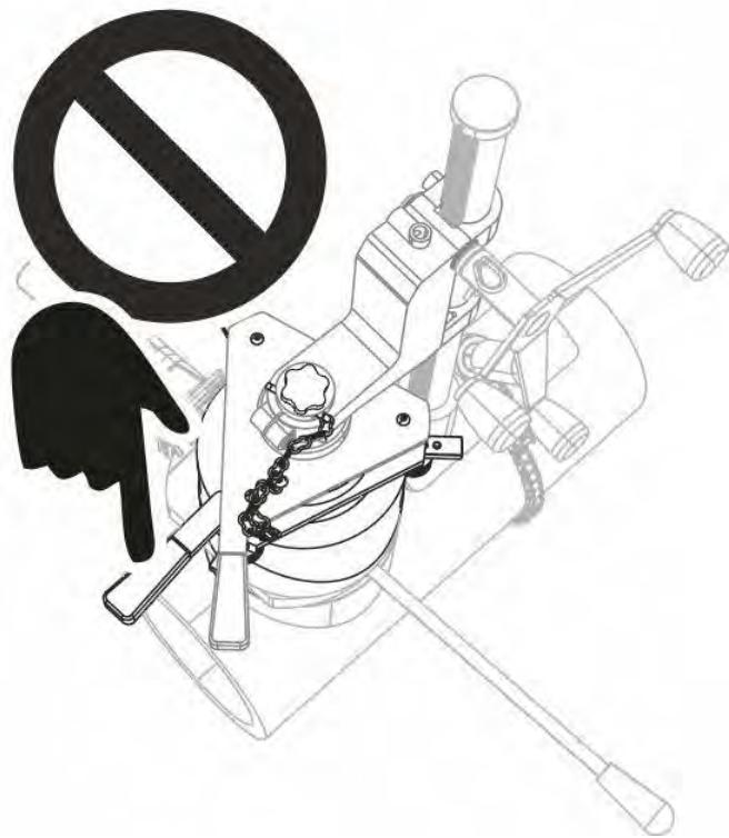
Al termine della fase di riscaldamento sollevare rapidamente il raccordo per estrarre il polifusore.
